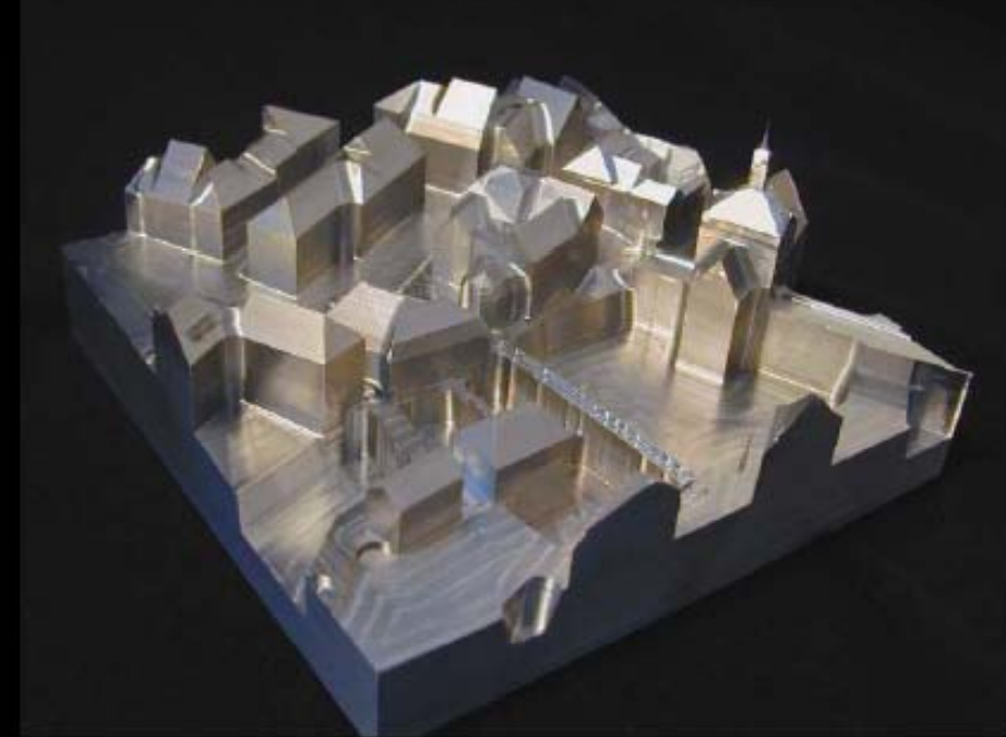
Per Rapid Prototyping erzeugtes Aluminium-Modell
